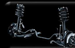
Suspensión Delantera McPherson + Barra estabilizadora
